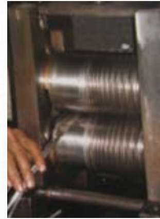
Çubuk halindeki gümüş silindirden geçirilerek inceltilmesi
