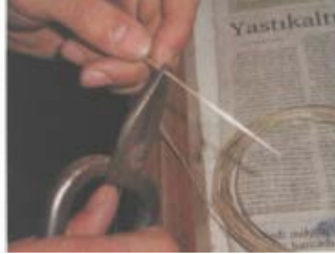
Yassılaştırılmış telin yapılacak forma göre kesilmesi
